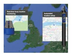
Kontinuierliches GPS - HydroVu verwendet das GPS von VuLink zur automatischen Lokalisierung und Markierung von Geräten auf Karten, synchronisiert Geräte und Standorte, erhöht die Datenqualität und erleichtert die Verfolgung von frei schwimmenden Bojen.
